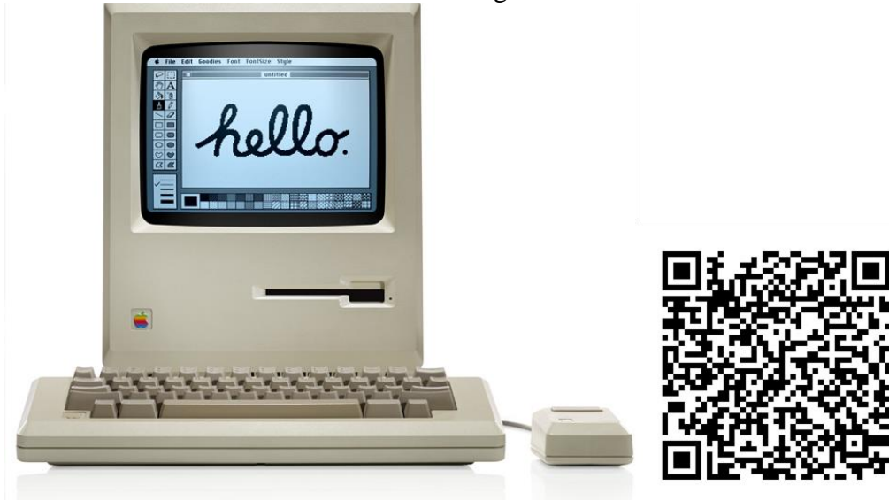
Figura 8 - O Macintosh, computador pessoal da Apple que inovou o mercado da informática ao introduzir uma interface gráfica e o mouse
