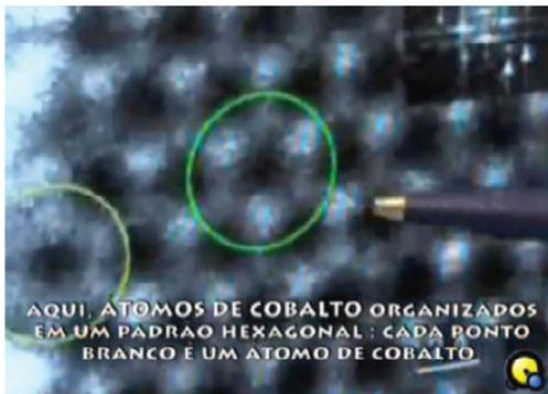
**É possível “ver” os átomos através de um microscópio de força atômica (FMA).**
