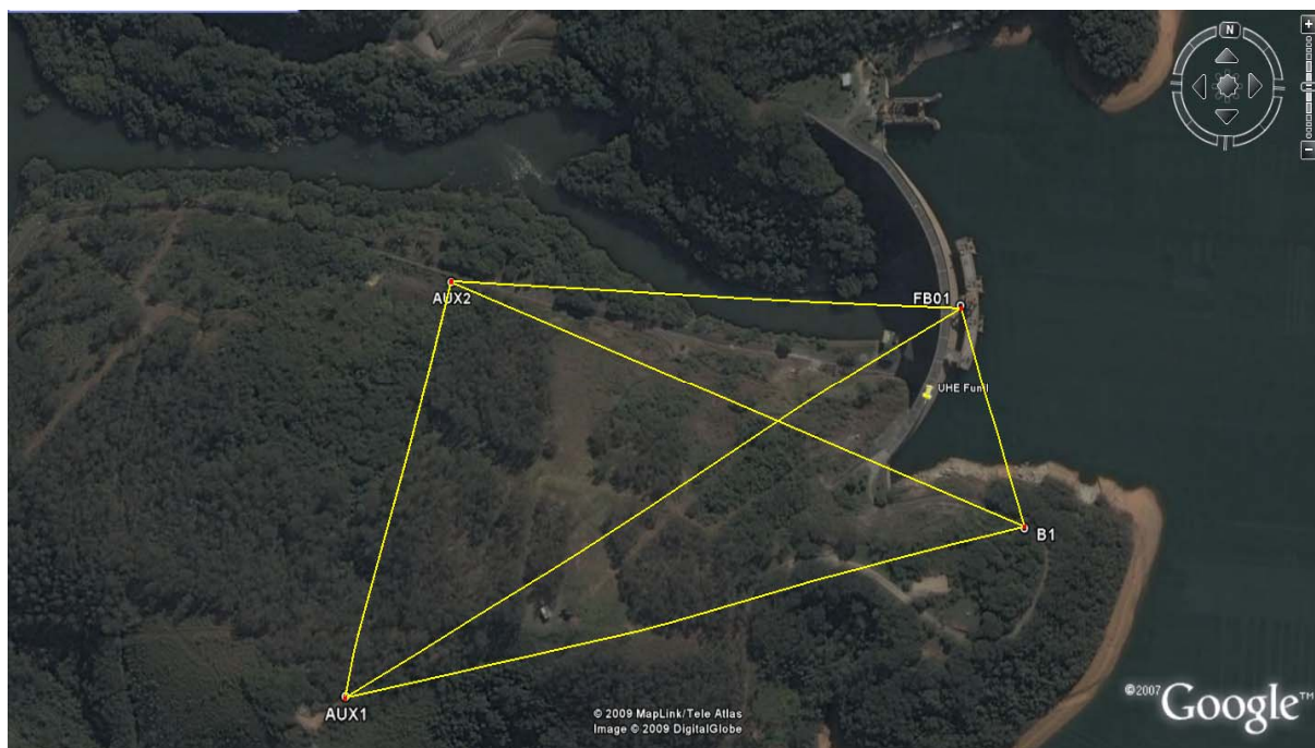
Figura 14 – Estrutura geodésica de controle e ponto monitorado na UHE Funil.
