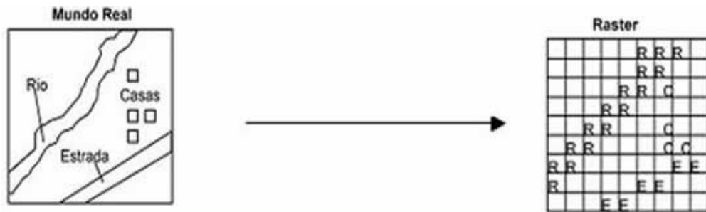
Figura 4 – Representação de um mapa do mundo real através de estrutura matricial ou raster (Fonte: SILVA, 2004)
