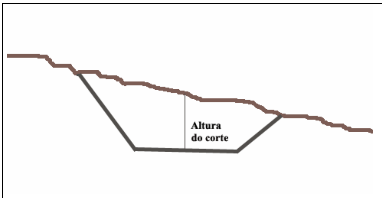
Figura 10 - Terraplanagem do tipo corte
