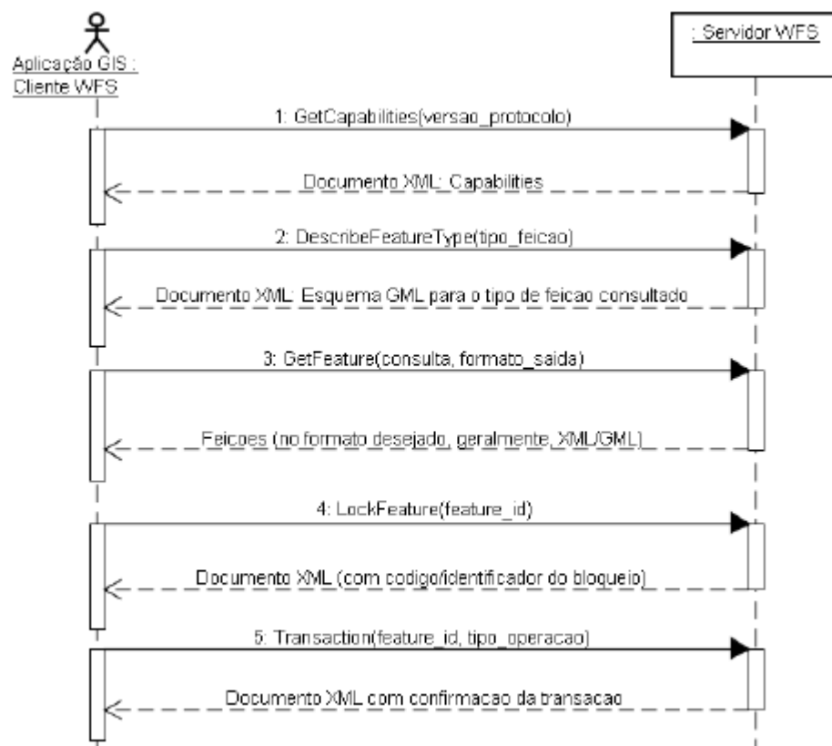
Figura 16: Diagrama de sequência que demonstra o funcionamento de um WFS (Queiroz 2007b).
