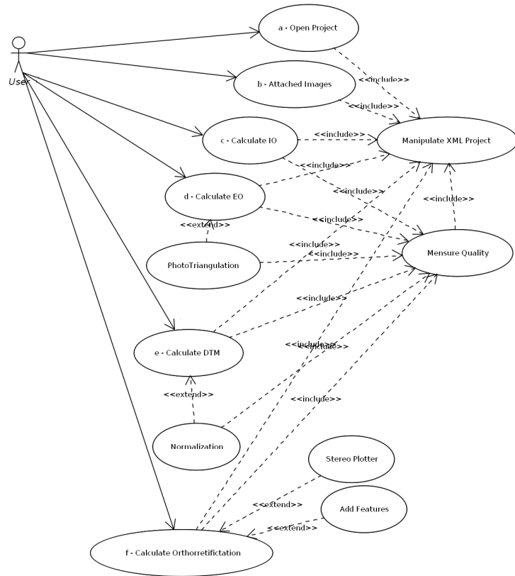
Figura 62 - Diagrama de Caso de Uso para a EFDE
