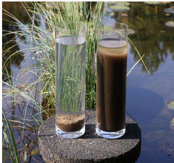
Figura 10 - Propriedades de sedimentação da biomassa granular aeróbia comparada ao lodo ativado. O lodo granular está no recipiente à esquerda e o lodo ativado à direita.
