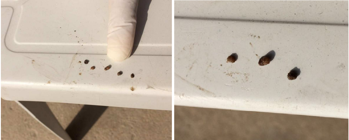
Figura 31 - Grânulos retirados do reator biológico da ETE Deodoro com aproximadamente 2,0 mm.
