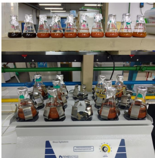
Figura 16 – Ensaio de equilíbrio em lote com solo (Acervo pessoal)
