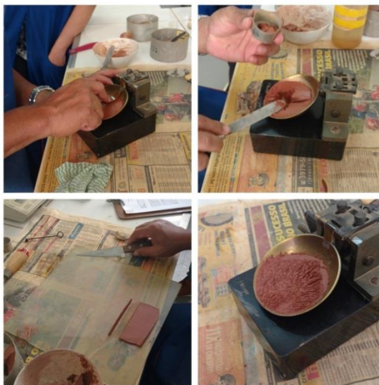
Figura 14 – Ensaio de Limites de Plasticidade e Liquidez (Acervo pessoal)
