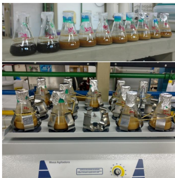
Figura 15 – Ensaio de equilíbrio em lote com bentonita (Acervo pessoal)
