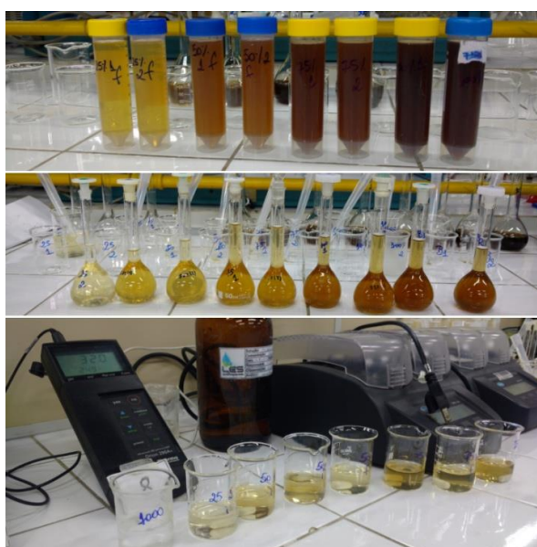
Figura 18 – Diluições e análise de Nitrogênio amoniacal (Acervo pessoal)
