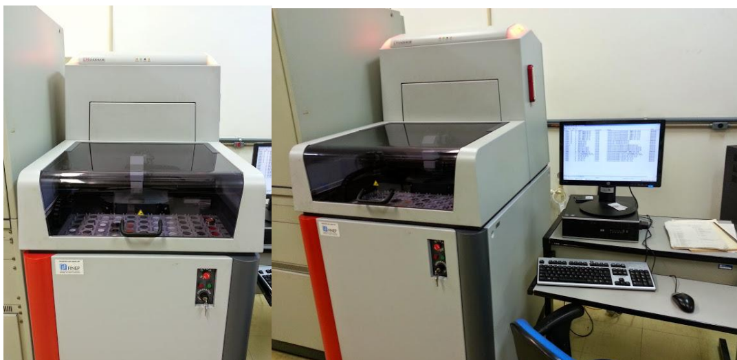
Figura 16 - Difrator de Raio-X Bruker D4 Endeavor em funcionamento (CETEM)
