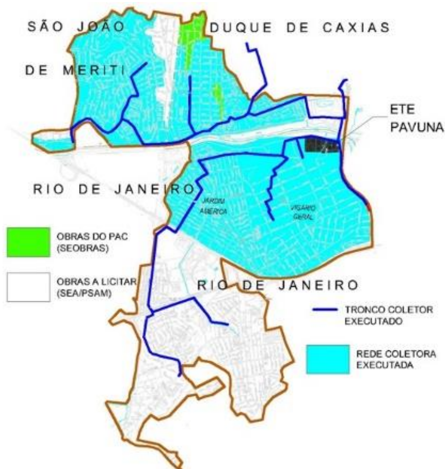
Figura 23: Tronco coletores e redes de esgoto do sistema Pavuna
