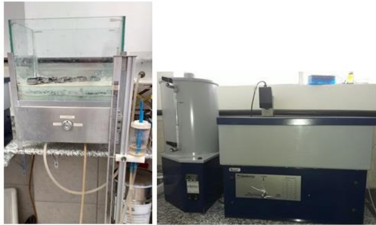
Figura 11 – Mesa de tensão de areia e mesa de tensão de areia-caolin com bomba de vácuo. (Acervo pessoal)
