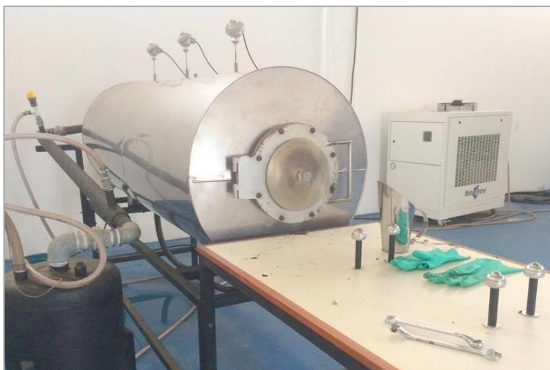
Figura 5 – Reator para carbonização dos resíduos orgânicos. Fonte: Resende, 2016.
