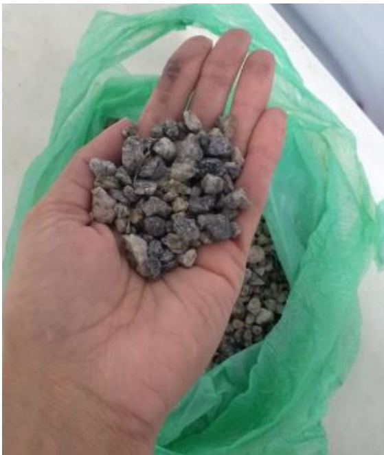
Figura 10 - Fotografia da brita 0 utilizada nos Filtros Simples e duplo
