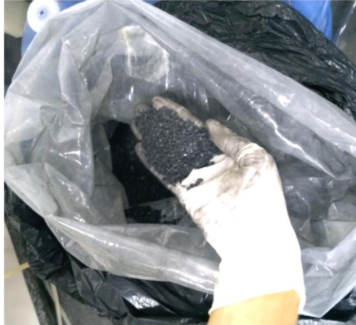
Figura 12 - Fotografia do carvão ativado utilizado no filtro de camada dupla
