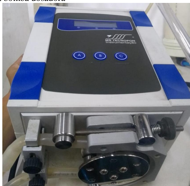
Figura 15 - Fotografia da bomba dosadora
