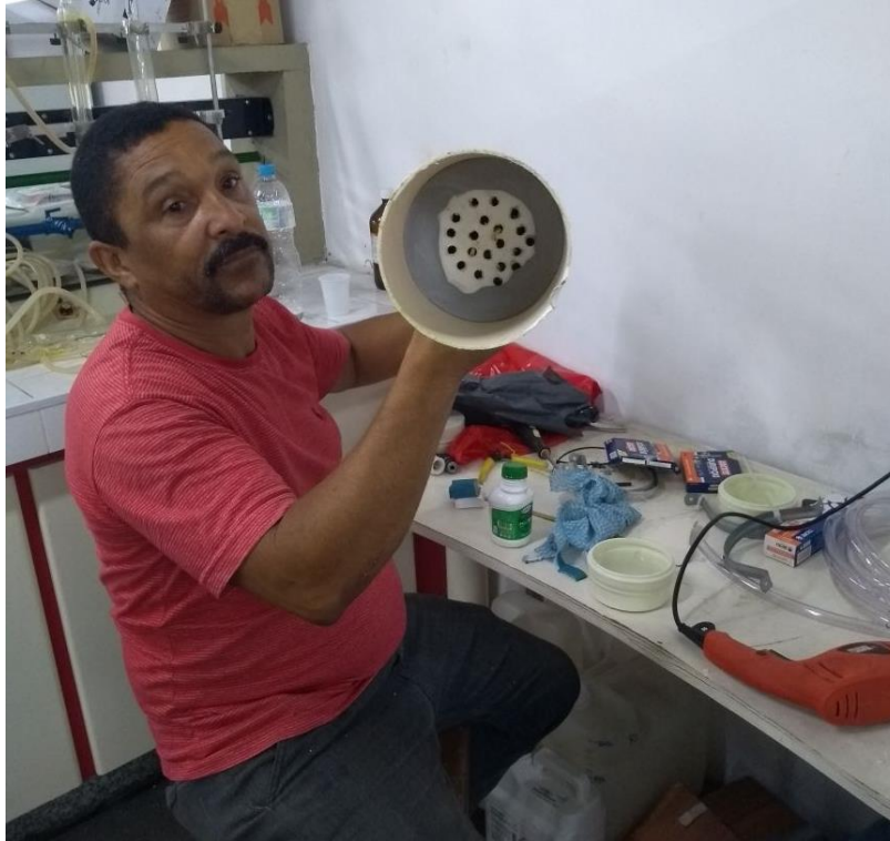
Figura 13 - Fotografia realizada durante o procedimento de instalação do fundo falso
