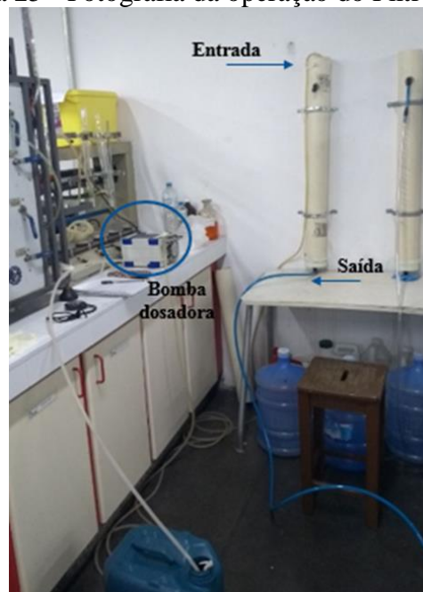
Figura 25 - Fotografia da operação do Filtro Duplo
