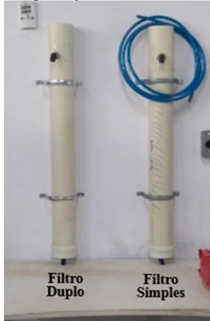
Figura 24 - Fotografia da Implantação dos filtros terciários em escala de bancada
