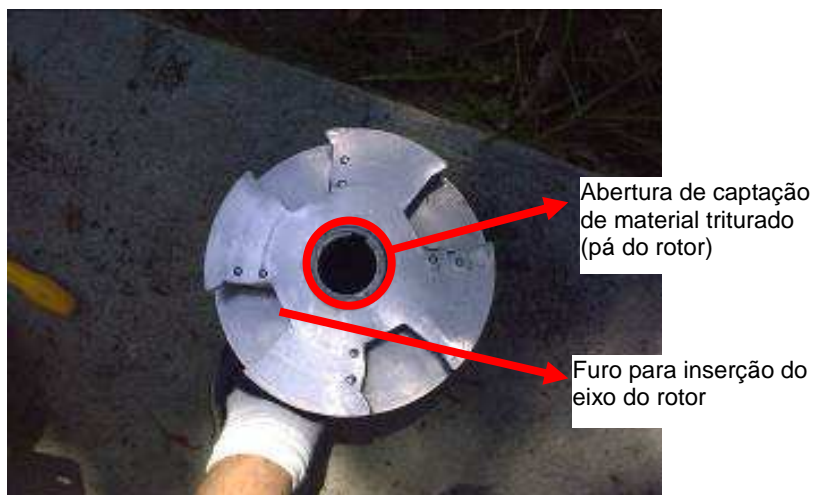
Figura 9. Rotor de alimentação do reator (Foto: R. S. Muniz, 2009).
