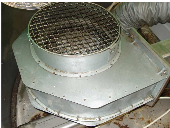
Figura 11. Ventoinha localizada na parte superior do reator (Foto: R. S. Muniz, 2009).
