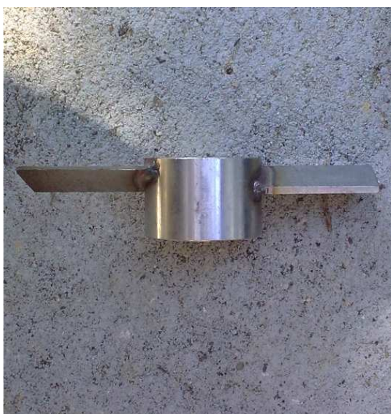
Figura 10. Hélice típica do sistema de trituração (Foto: R. S. Muniz, 2009).
