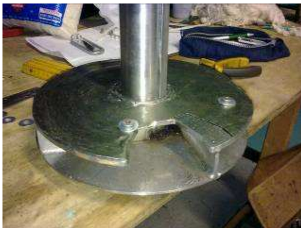
Figura 21 - Rotor com apenas uma pá (Foto: R. S. Muniz, 2009).
