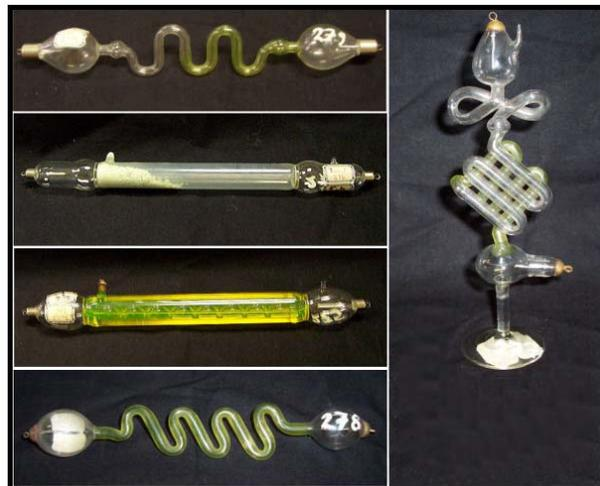
**Figura 1.13.** Exemplo de tubo de Geissler.
