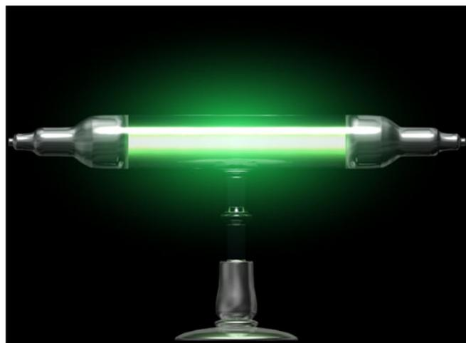
Figura 1.14. Tubo de Crookes iluminado. Fonte: [www.if.ufrgs.br](http://www.if.ufrgs.br), 2013.
