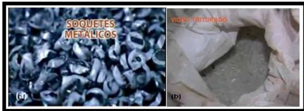
**Figuras 2.5**(a)Soquetes metálicos separados do vidro das lâmpadas e (b) Vidro flocado do processo. Fonte:Apliquim Brasil Recycle-Paulínia-SP,2013.
