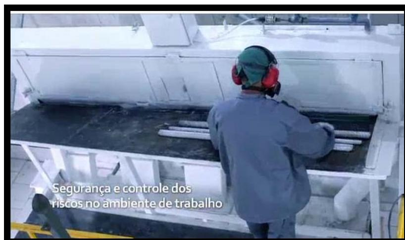
**Figura 2.4-** Equipamento de ruptura e moagem de lâmpadas. Fonte:Apliquim Brasil Recycle-Paulínia-SP,2013.
