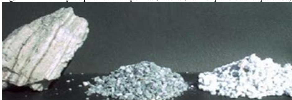
Figura 10 – Variações possíveis da perlita (natural, semiexpandida e expandida)
