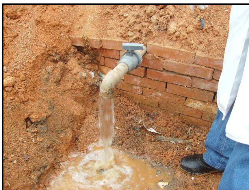
Figura 34 – Aspecto do percolado gerado na Célula C1, 15 dias após o fechamento
