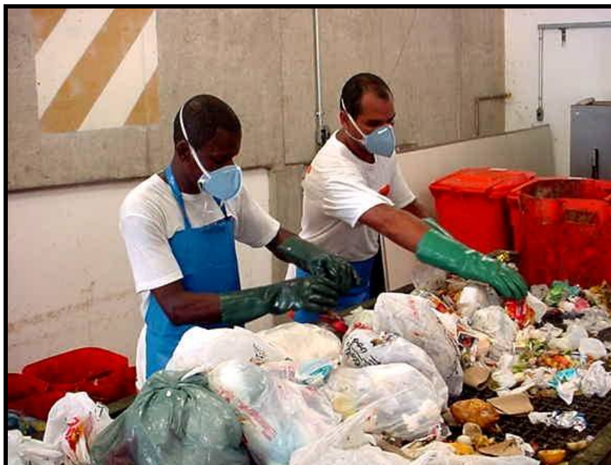
Figura 25 – Mesa de caracterização gravimétrica
