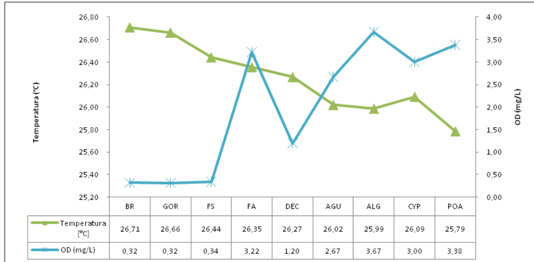
Figura 27 - Comparação das variáveis Temperatura e Oxigênio dissolvido (OD) ao longo do sistema, durante o período de monitoramento.
