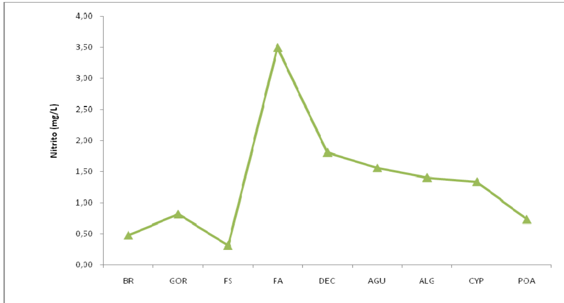
Figura 37 - Valores médios de nitrito em cada tanque ao longo do sistema, durante o período de monitoramento.
