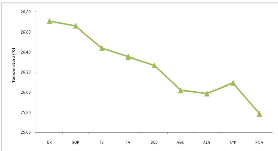
Figura 26 - Valores médios de temperatura do efluente em cada ponto de coleta, ao longo do sistema, durante o período de monitoramento.
