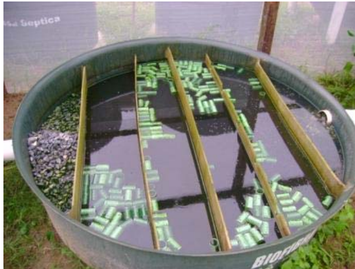
Figura 20 -1 Tanque de algas com chincanas verticais e bobs.
