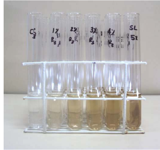
Figura 2.2 Série de cinco diluições (mais o controle) de um ensaio com Daphnia similis
