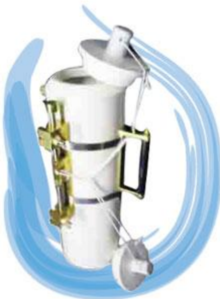
Figura 16 – Garrafa de Van D'orn de descida horizontal muito utilizada em trabalhos ordinários de campo.
