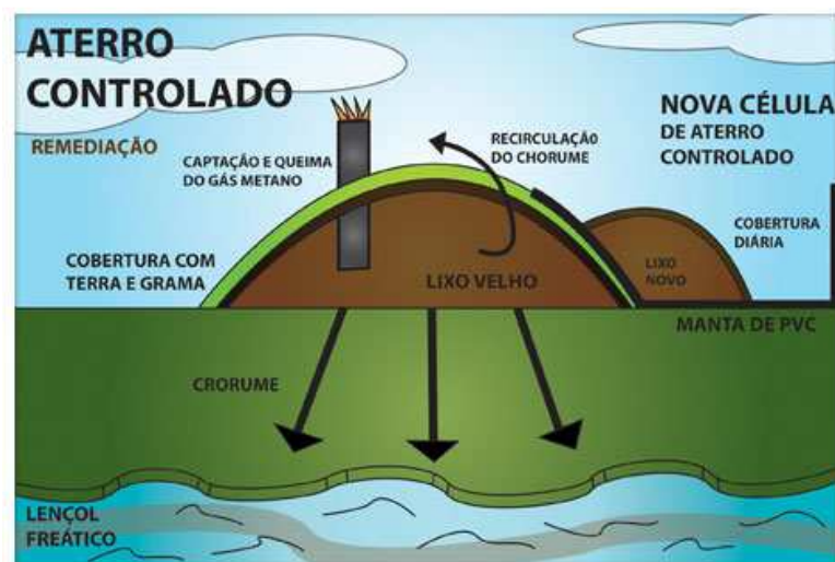
Figura 2: Esquema ilustrativo de um aterro controlado. Fonte: SILVA, 2012
