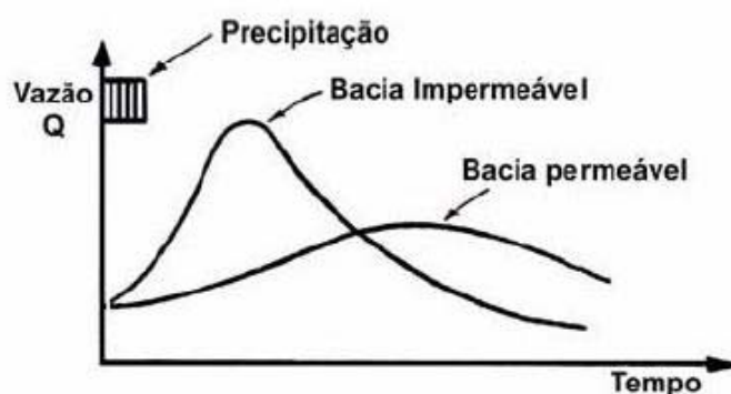
Figura 10 – Caracterização da vazão de um rio de acordo com a permeabilidade do solo Fonte: Silva et al , 2003
