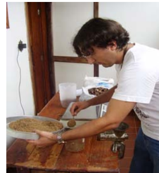
Figura 49. Retorno dos caroços de açai ao Becker de medição volumétrica (1 litro) para verificação da redução ou o crescimento volumétrico dos caroços de açai triturados
