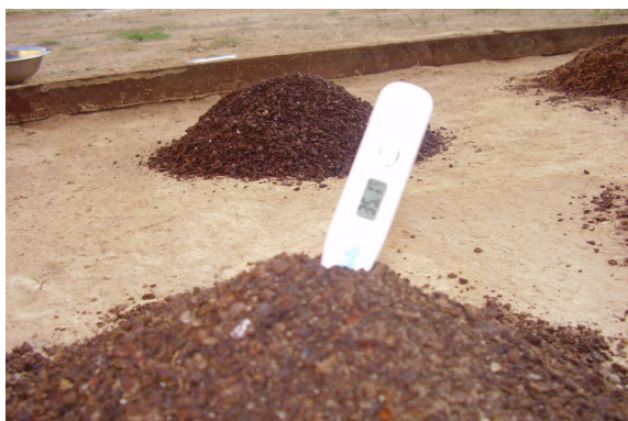
Figura 77. Detalhe da medição e controle da temperatura das pilhas durante todo o processo de compostagem.
