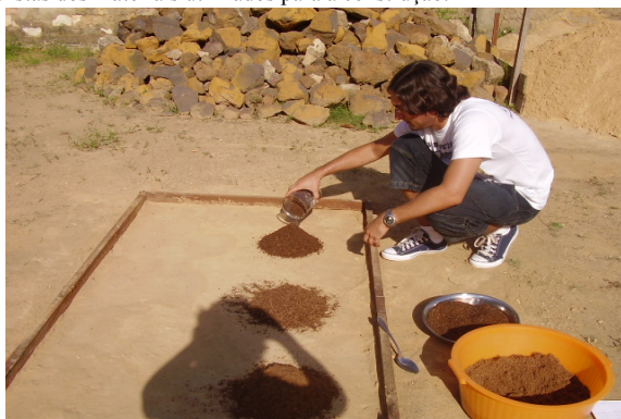
Figura 63. Montagem da Pilha 03. Vista das pilhas 01 e 02 montadas e já misturadas, conforme a composição da Tabela 10.
