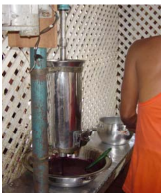
Figura 08. Foto de uma máquina bateadeira do açaí que faz a extração do suco (separação da polpa e dos caroços). Fontes diretas de produção de resíduos “caroços de açaí”, onde são recolhidos, segregados na origem, sem contato manual
