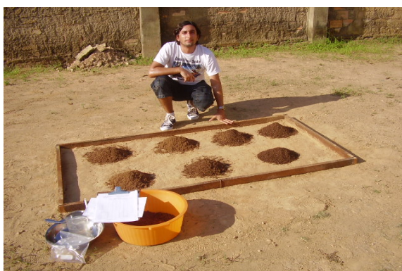
Figura 67. Pátio experimental de compostagem finalizado, com as sete (7) pilhas montadas, conforme a Tabela 09. da esquerda para a direita, embaixo: Pilhas: 01, 02 e 03. Na parte superior, no mesmo sentido, as Pilhas: 04, 05, 06 e 07.
