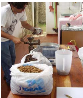
Figura 52. Após a anotação da pesagem e verificação do volume de 1 litro de resíduo, a transferência das cascas de castanha para o triturador manual.
