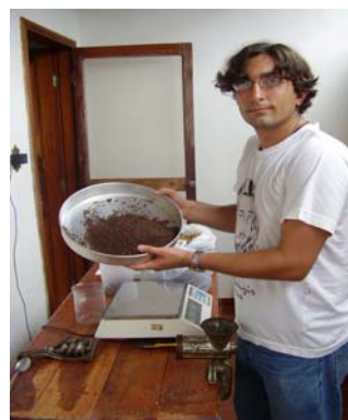
Figura 55. Vista de 1 litro de cascas de castanha trituradas. Também houve o retorno das cascas de castanha ao Becker de medição volumétrica (1 litro) para verificação da redução ou o crescimento volumétrico das cascas de castanha trituradas
