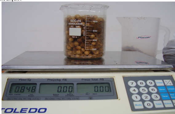
Figura 44. Detalhe da medição do peso e da quantidade volumétrica de caroços de açai no Becker de 1 litro (a medida é visual, na marcação, por acomodação normal, sem compactação no Becker).
