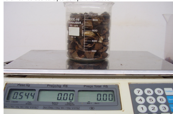
Figura 51. Detalhe da medição do peso e da quantidade volumétrica de cascas de castanha no Becker de 1 litro (a medida é visual, na marcação, por acomodação normal, sem compactação no Becker).
