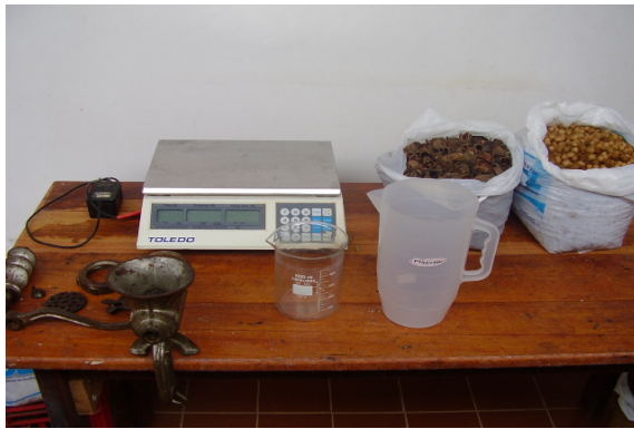
Figura 38. Foto dos materiais utilizados no procedimento da determinação do peso específico dos resíduos.
