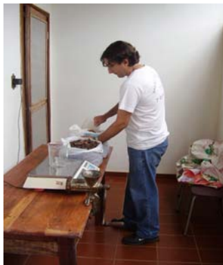
Figura 42. Início do procedimento da determinação do peso específico dos resíduos. Coleta de quantidade de caroços de açai para medição.
