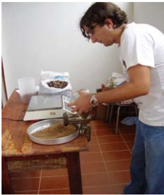
Figura 46. Trituração dos caroços de açai. Processo muito difícil pelas características compactas dos caroços.
