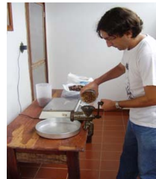
Figura 45. Após a anotação da pesagem e verificação do volume de 1 litro de resíduo, a transferência dos caroços de açai para o triturador manual.
