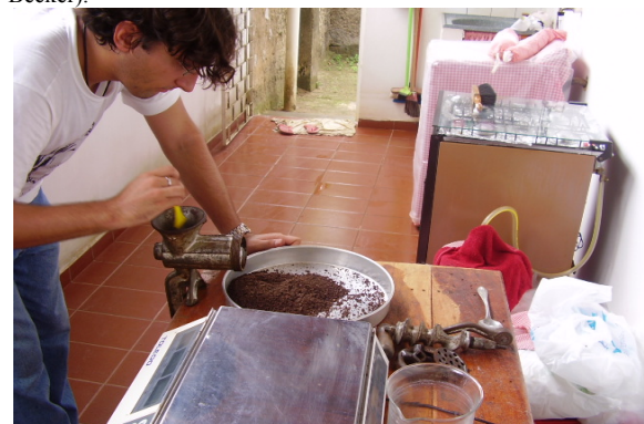
Figura 53. Trituração das cascas de castanha. Processo mais fácil pelas características das cascas e do grande volume de vazios.
