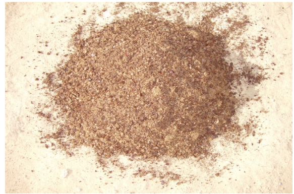
Figura 70. Detalhe da vista da Pilha 02. 50% Caroços de açai e 50% Cascas de castanha
