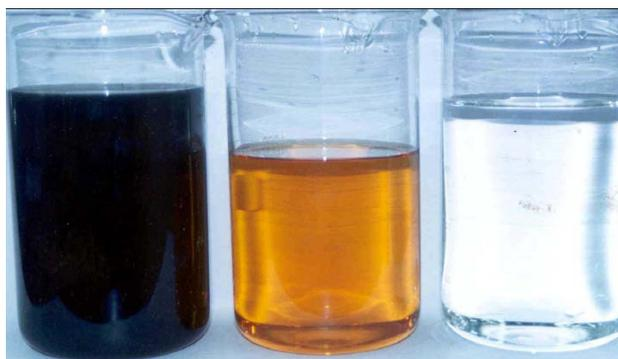
Figura 1 – Aspecto do lixiviado bruto (à esquerda), clarificado com cal (no centro) e permeado na membrana de nanofiltração (à direita).
