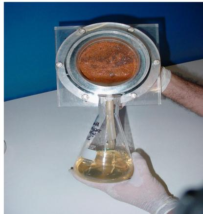
Figura 25 - Retirada do lixiviado da célula.
