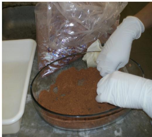
Figura 8 – Destorroamento do solo.
