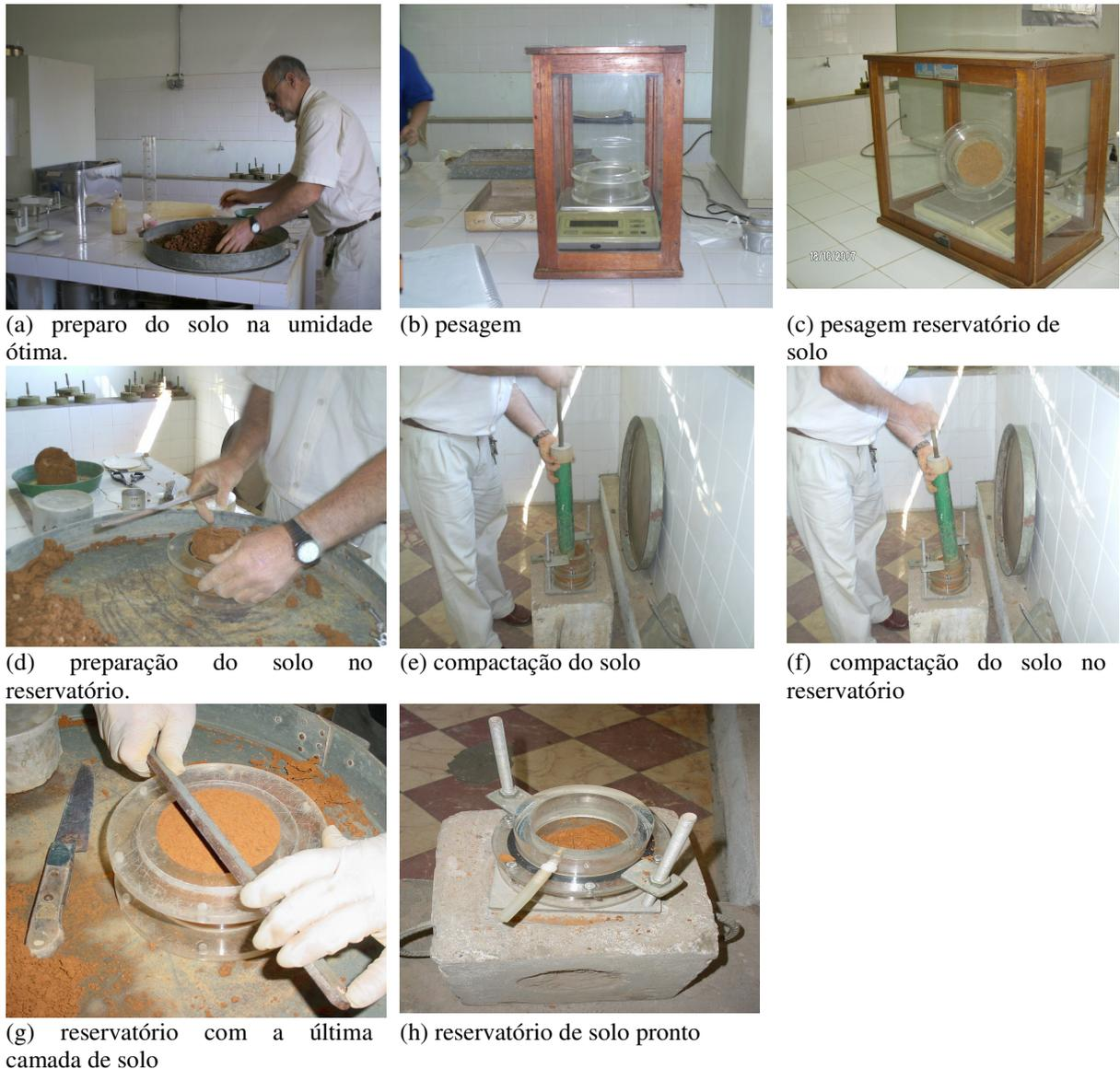
Figura 22 - Preparo do solo na umidade ótica, pesagem, preenchimento e compactação da célula de difusão.
