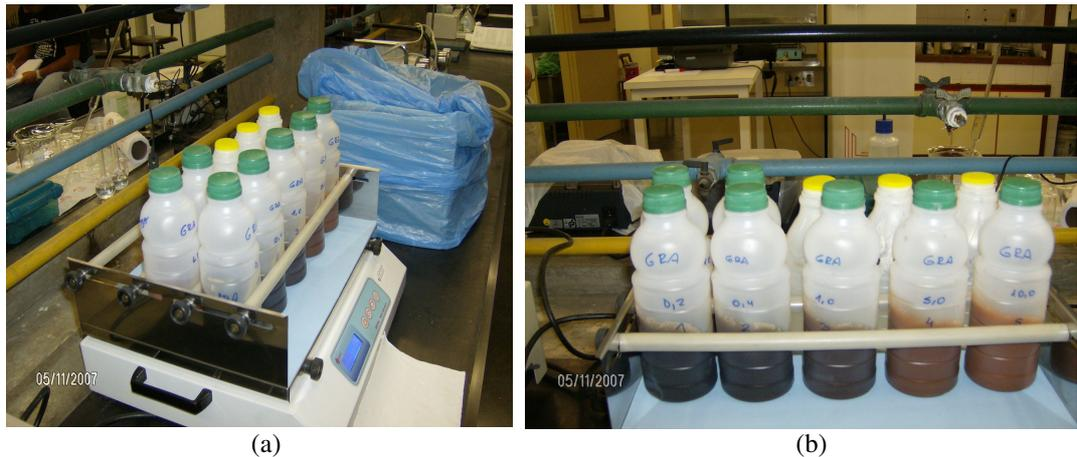
Figura 18 – (a) Frascos na mesa agitadora e (b) Amostras do Lixiviado do AGP na mesa agitadora.
