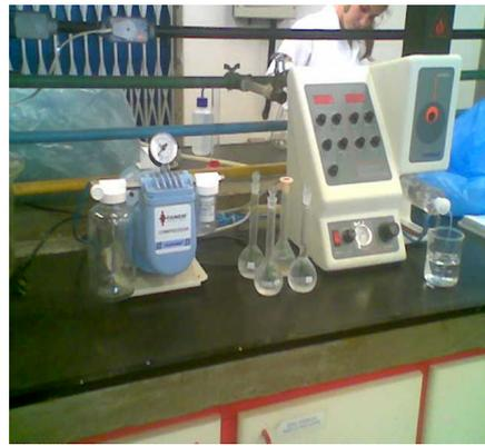
(b) Fotômetro e bomba de vácuo.
