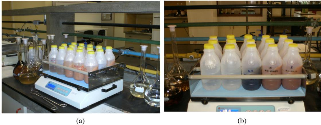
Figura 11 – Frascos contendo os ensaios no *shaker*
