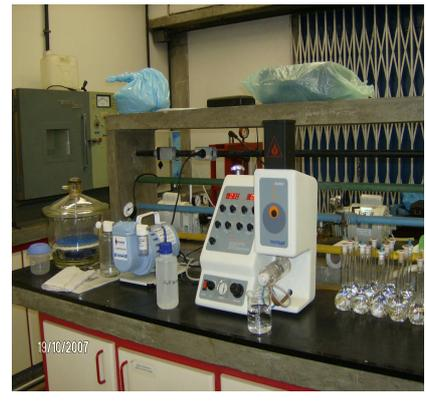
(c) Conjunto Fotômetro, Bomba de vácuo e soluções padrão
