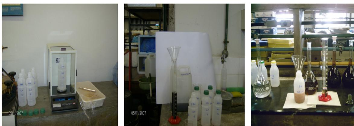
Figura 17 – (a) Pesagem de solo; (b) preparação do lixiviado do Aterro de Grande Porte nos frascos para sorção pelo Método ECI (c) lixiviado no frasco e no balão volumétrico.
