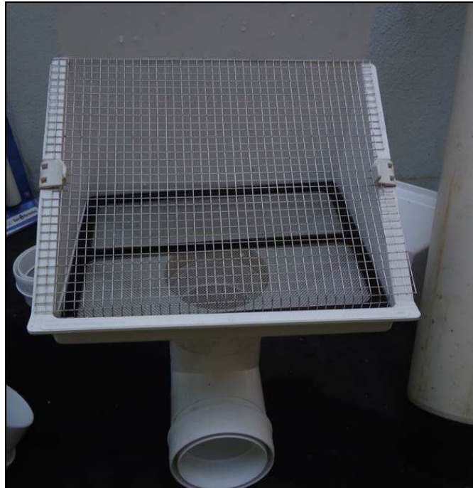
Figura 16: Tela de filtragem para separação de material grosseiro.
