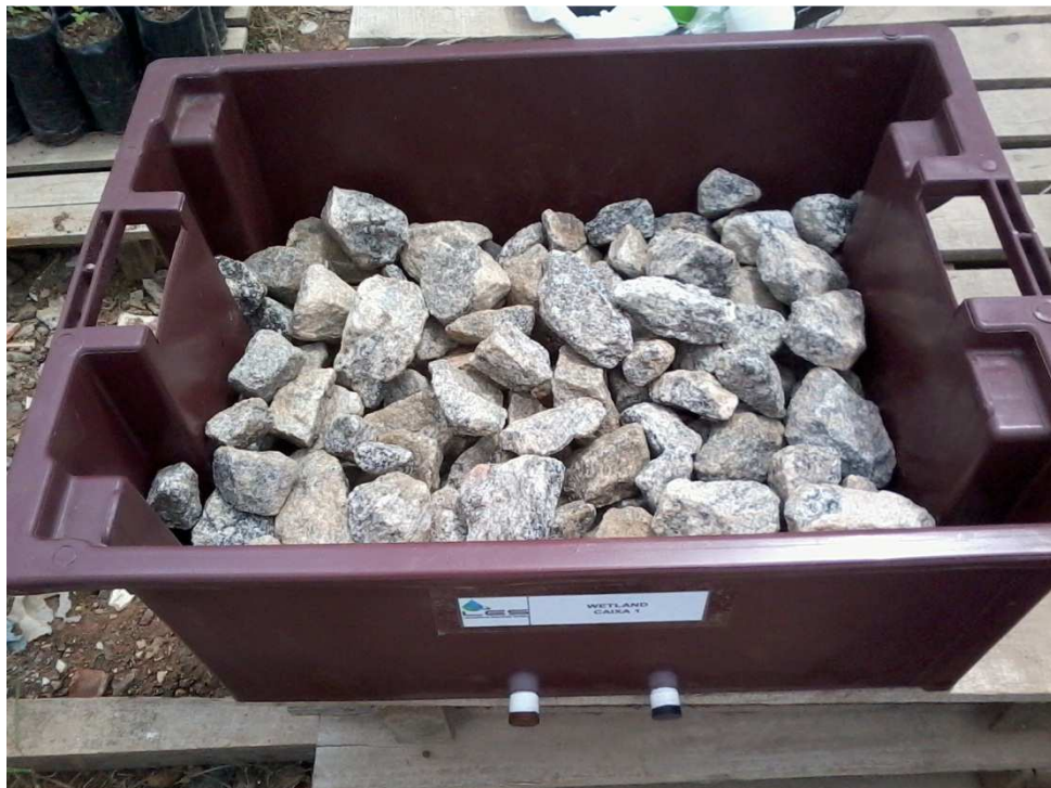
Figura 11 - Fotografia de uma das caixas preenchida com brita, durante a montagem dos protótipos.
