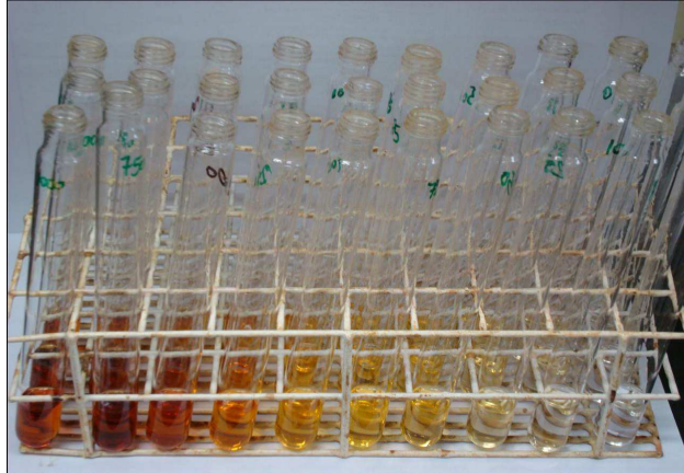
Figura 6. Foto dos tubos com as diluições preparadas para a construção da curva de calibração para análises de carboidratos.
