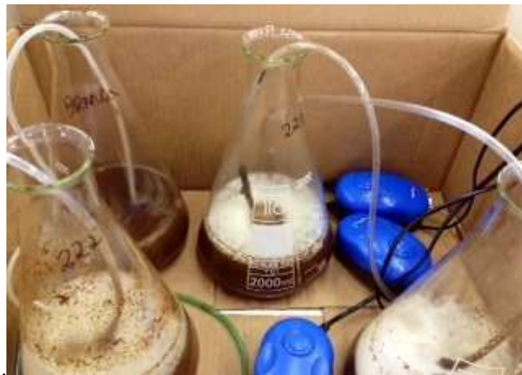
Figura 5. Reatores Biológicos e aeradores utilizados nos ensaios de biodegradabilidade aeróbica.
