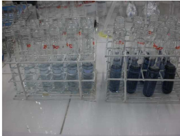
Figura 8. Foto dos tubos de ensaio com as diluições para a preparação da curva de calibração para a determinação do teor de substâncias húmicas nas amostras.
