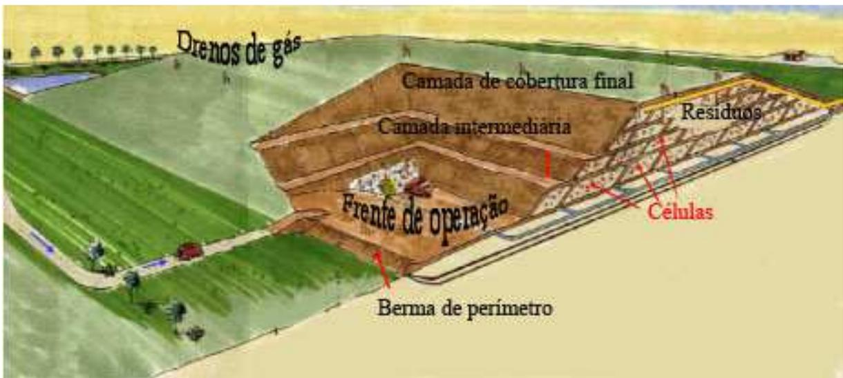
Figura 4: Esquema típico de funcionamento de um aterro sanitário.
