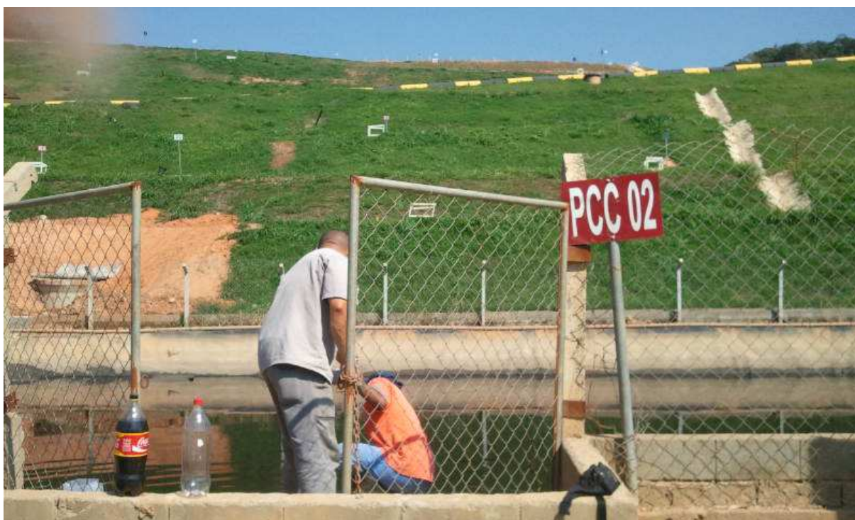
Figura 16: Coleta de amostra na lagoa de acumulação de lixiviados - CTR Nova Iguaçu. Fonte: Própria.
