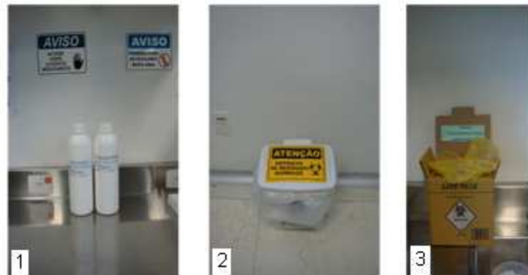
Figura 16 – 1) Frascos de descarte para resíduos químicos líquidos; 2) Embalagem de descarte de resíduo químico sólido; 3) Embalagem de descarte de perfurocortante Fonte: Adriana Zwetsch.
