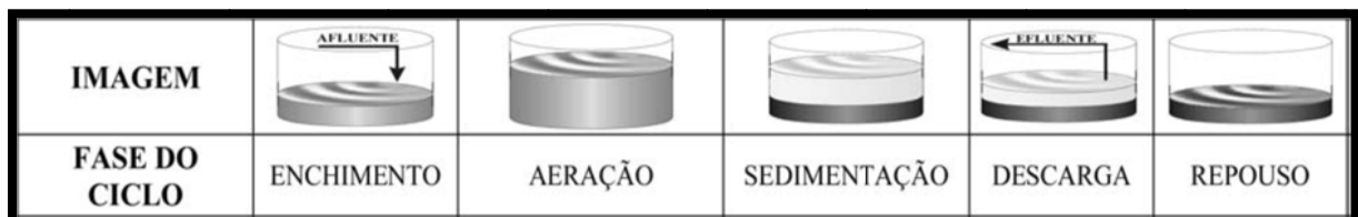
Figura 1.2. – Ciclos do processo de operação um reator em bateladas (Santos et al , 2006).
