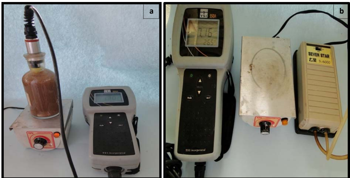
Figura 5.5. Realização do teste de respiração (a) e aparelhos utilizados durante as análises (b).
