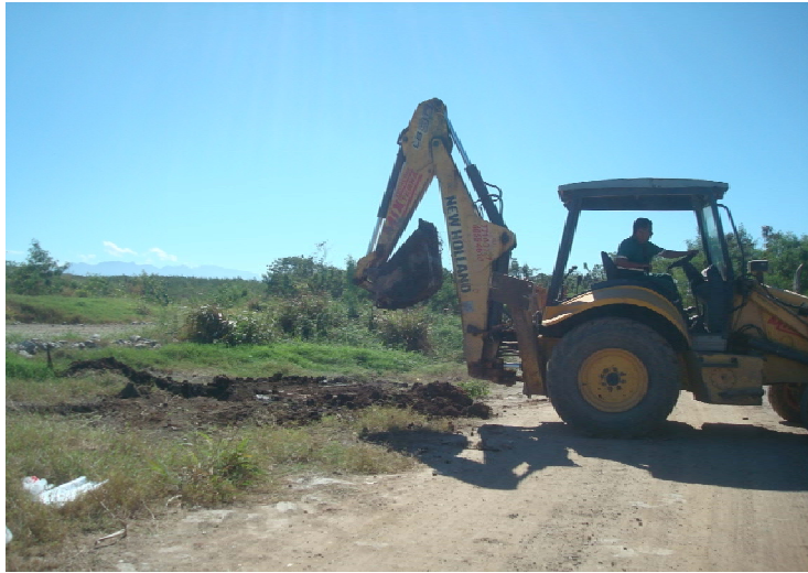
Figura 3.5: Terceira coleta de amostras em solo mais profundo no Trecho 3 da barreira lateral em agosto de 2012.
