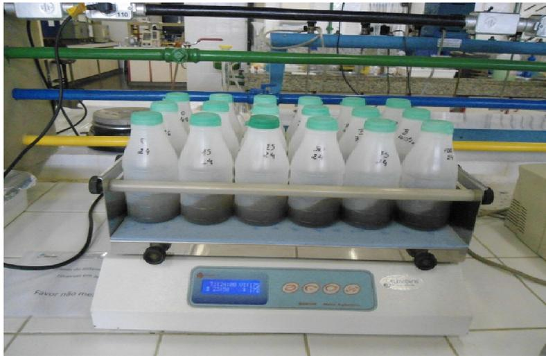
Figura 3.7: Foto dos frascos com as amostras sendo agitados no shaker.
