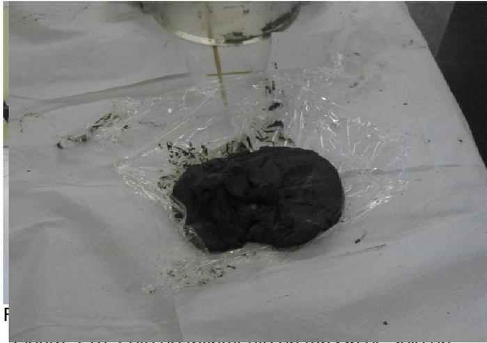
Figura 3.10: Foto do repartimento da massa de solo em fatias da célula de difusão.
