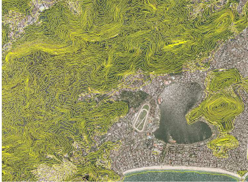
Figura 10: Representação vetorial do relevo através das curvas de nível
