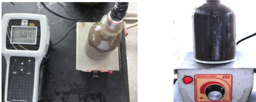
Figuras 3.5(a e b): Esquema do teste respirométrico – Oxímetro, agitador magnético e frasco de DBO com amostra.
