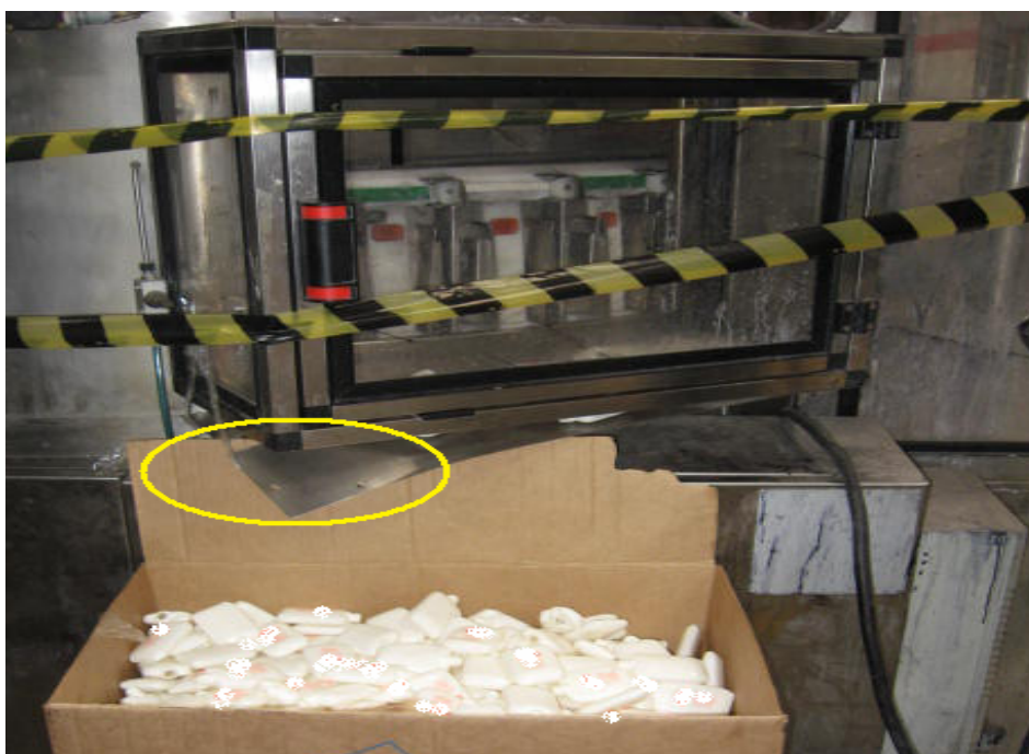
Figura 17 - Acidente março/2008 (abertura na proteção do equipamento)
