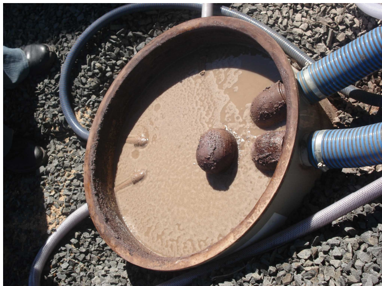
Aspecto do tanque de circulação e do líquido para umidificação do leito
