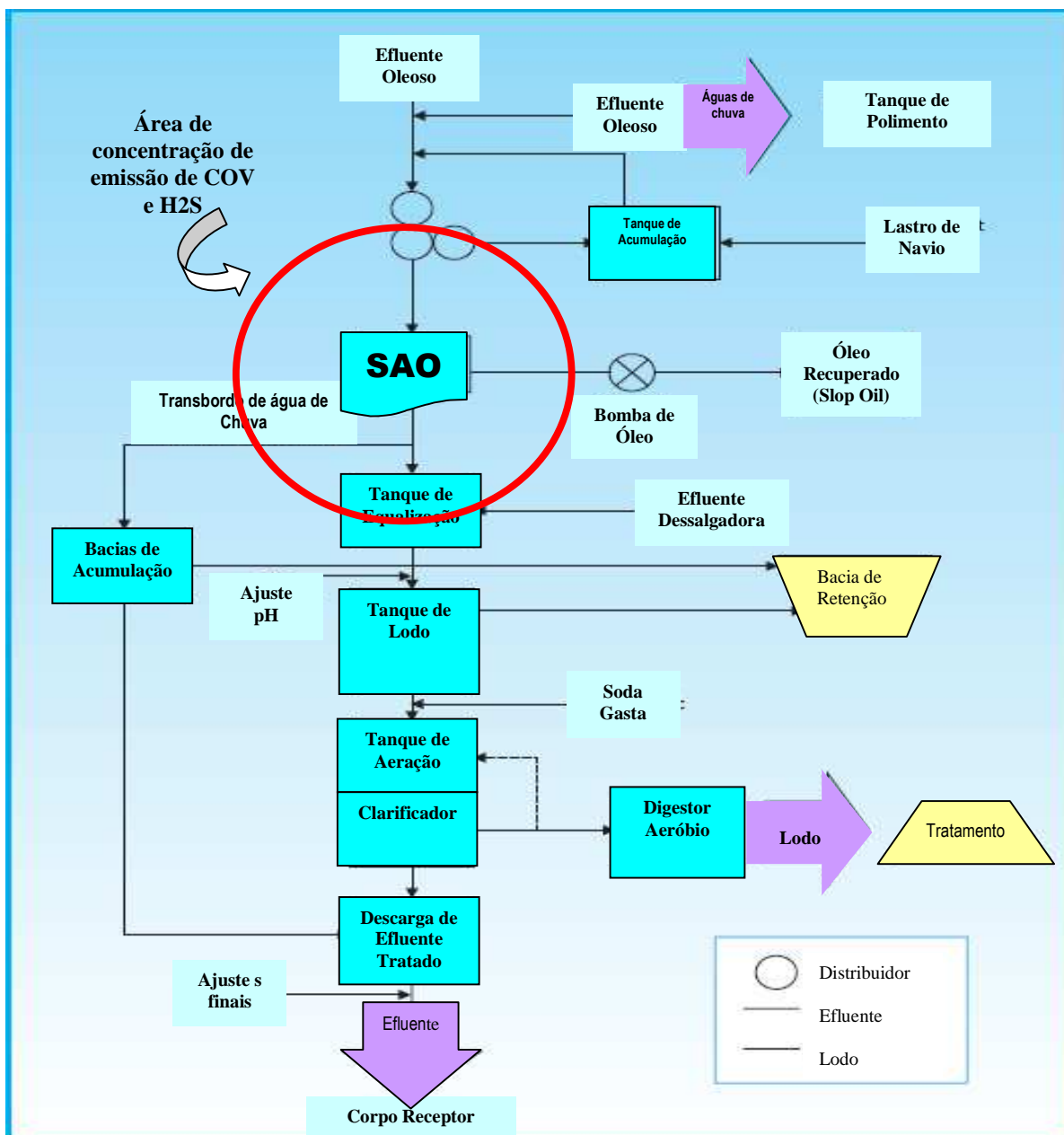
Figura 5 - Esquema Genérico de Unidade de Tratamento de Efluentes e Despejos Industriais - ETDI
