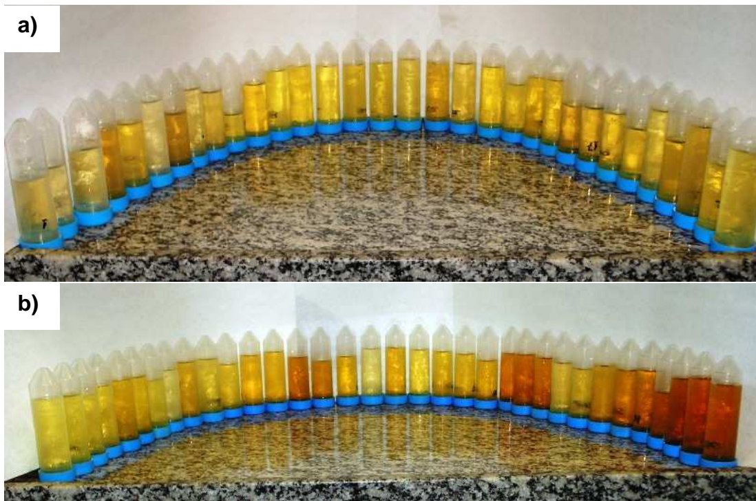
Figura 15. Visualização da cor das amostras obtidas durante os ensaios no teste de colunas: a) i = 8,77 mm/h; b) i = 42 mm/h.
