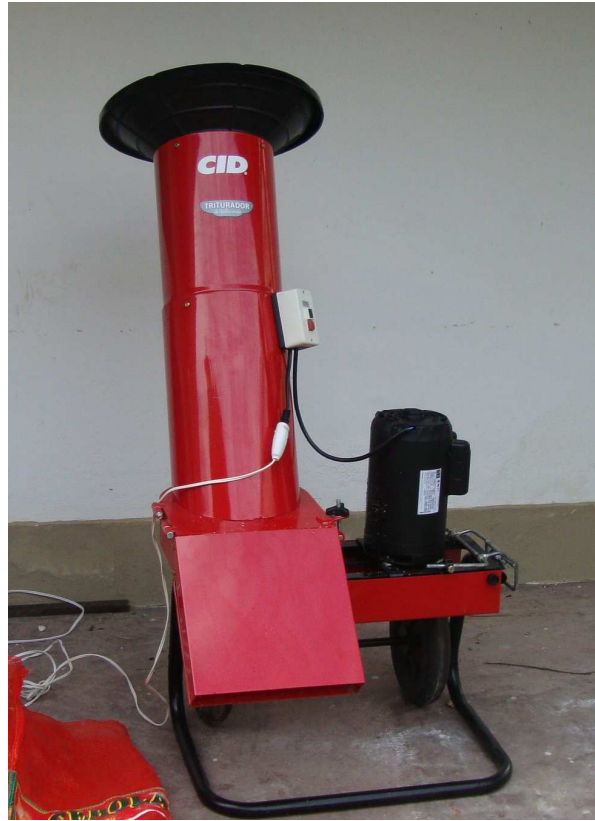
Figura 7. Máquina trituradora para galhos verdes
