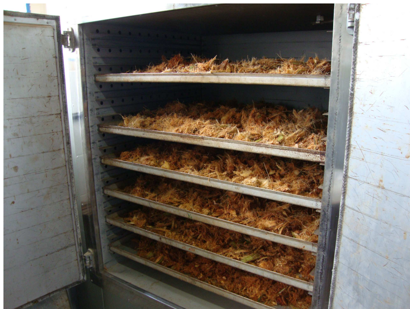
Figura 8. Cascas de coco trituradas e espalhadas em bandejas para secagem em estufa
