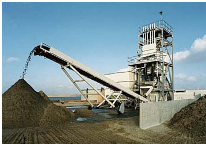
Figura 16: Hidrociclone utilizado para separação e desidratação (Fonte: IADC/CEDA, 1997 – Environmental Aspects of Dredging – Guide 5)
