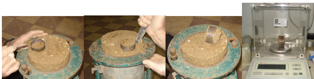
Figura 5.3: Seqüência da cravação do anel e obtenção dos pesos do conjunto amostra e anel
