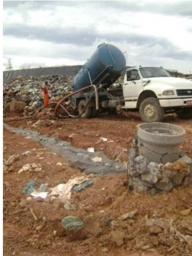
Figura 67 - Caminhão Limpa-fossa - CTR Macaé
