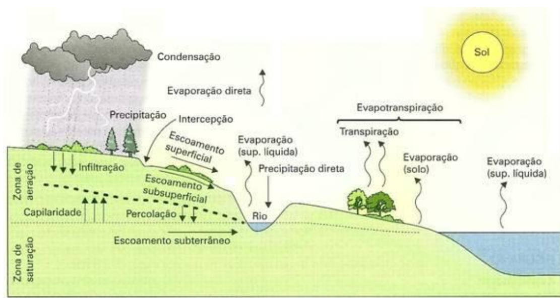
Figura 2. Representação esquemática do Ciclo Hidrológico.
