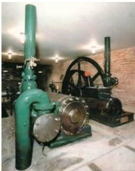
Figura 24. Bombas da elevatória da Glória fabricadas pela James Watt&Co. Fonte: Revista da SEAERJ, 1985 apud DIAS, 2003.
