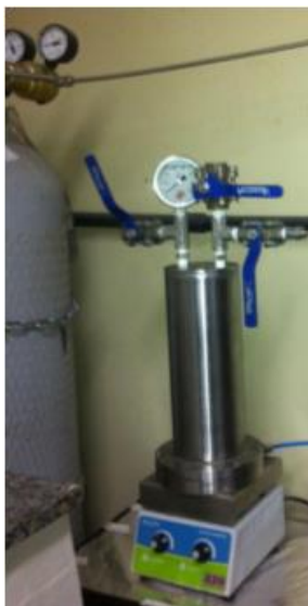
Figura 9 - Foto do equipamento de filtração por membranas utilizadas no fracionamento.
