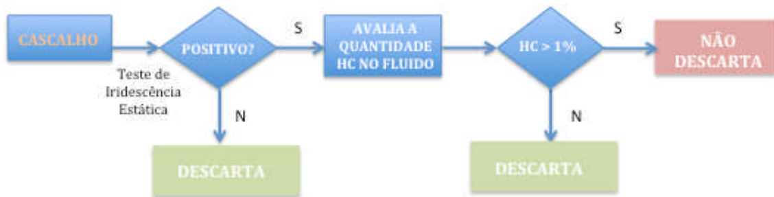
Figura 15 - Descarte de Cascavel com fluido de base aquosa aderido
