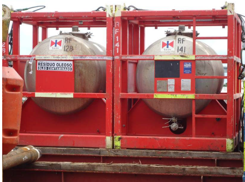
Figura 25 - Tanque para acondicionamento e transporte de água oleosa
