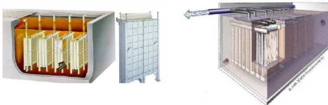
Figura 2.18. – Sistemas MBR com membranas submersas de placa plana e fibra oca, respectivamente. (CERQUEIRA, 2010).
