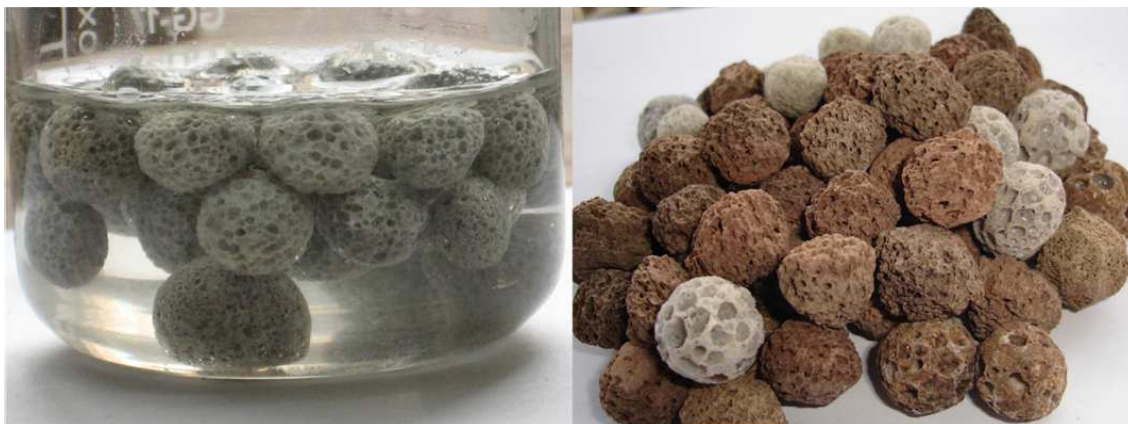
Figura 2.21. – Exemplo de suportes cerâmicos. Fonte: DONG et al. (2013).
