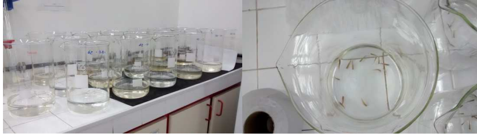
Figura 17 - Ensaio com Danio rerio em diferentes diluições.
