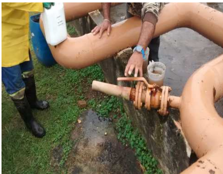
Figura 12 – Ponto de coleta na entrada do geobag.
