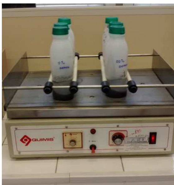
Figura 15 – Amostras na mesa agitadora.
