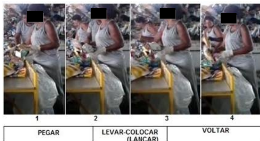
Figura 47 – Ciclograma de movimento corporal com os bags à frente da catadora C
