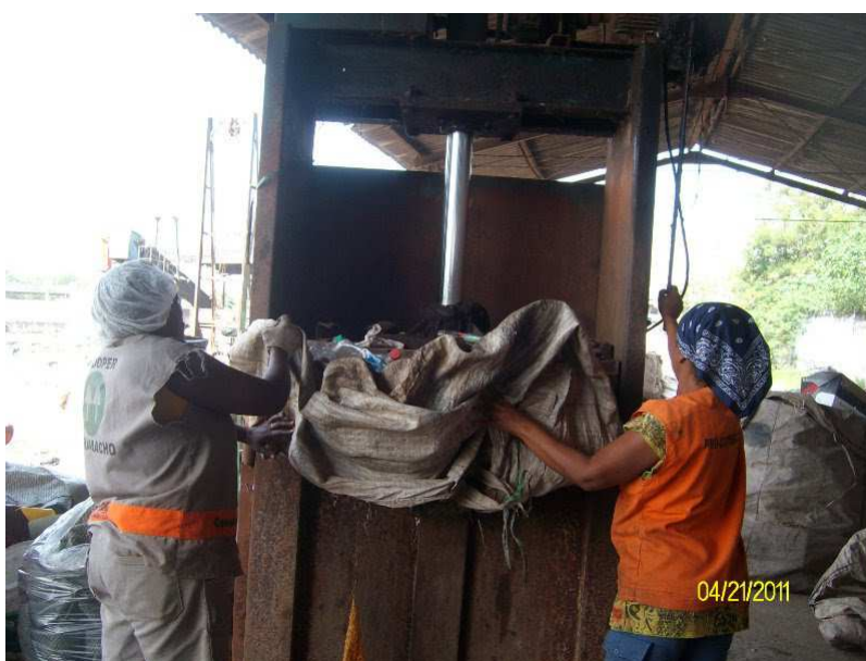
Foto 2- Compactação no material na prensa
