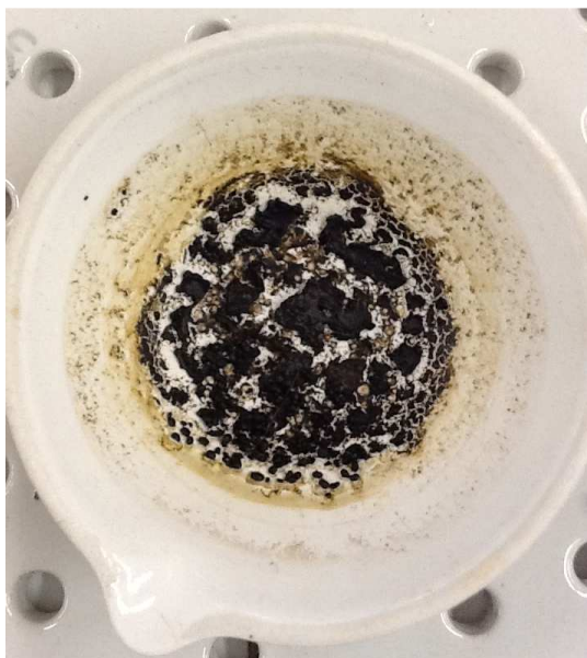
Figura 16 – Amostra de lodo anaeróbio, após secagem em placa de aquecimento, a 100° C, para determinação da concentração de Sólidos Totais (ST).
